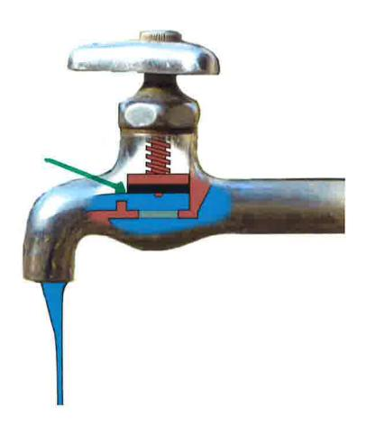
PREGUNTA 2. En este imagen de un grifo, señale con una flecha donde se instalaría un economizador o aireador de agua como el del modelo.
